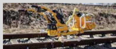
ROWRENCH 30.76 E 3 Aku přesná zatáčečka
