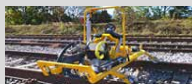
ROGRIND 13.63 Modulární bruska kolejnic a výhybek
